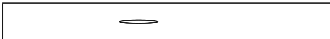
Пример 1 — одна несплошность длиной 12,7 мм
