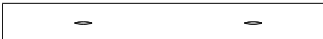
Пример 2 — две несплошности длиной по 6,4 мм
