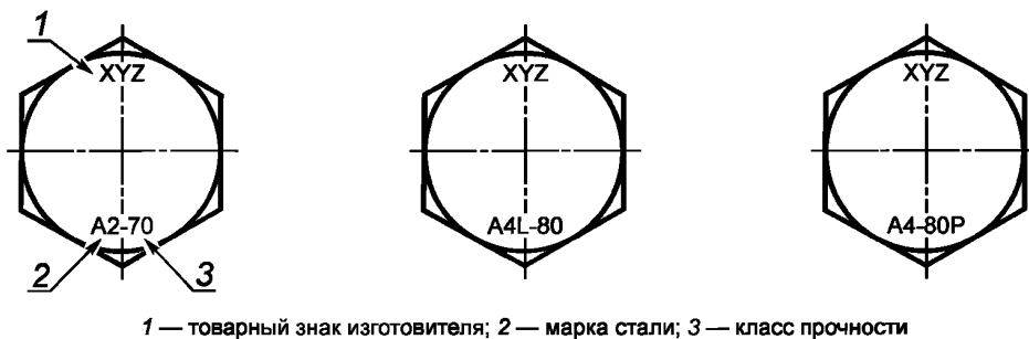
Рисунок 2 — Маркировка болтов и винтов с шестигранной головкой
