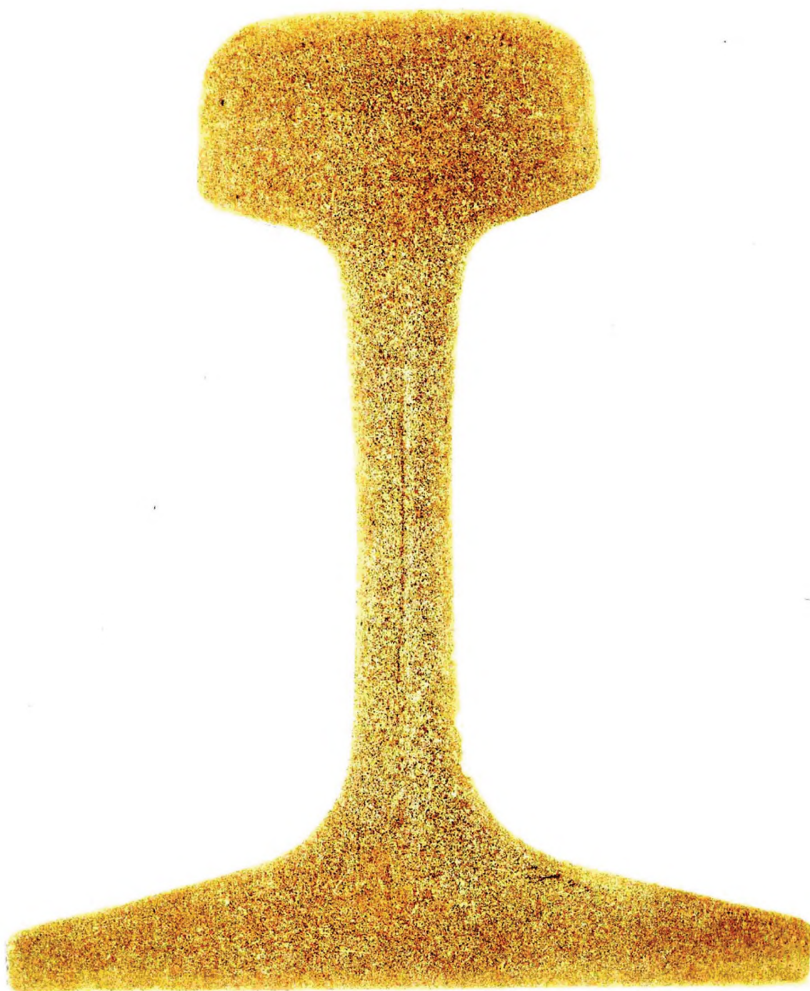
Рисунок И.13 — Ликвационные полосы (серный отпечаток)
