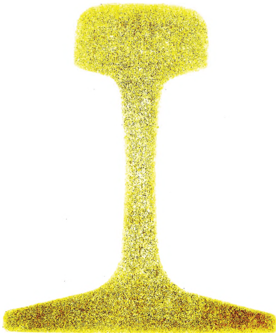
Рисунок И.1 — Макроструктура без ликвации (серный отпечаток)
