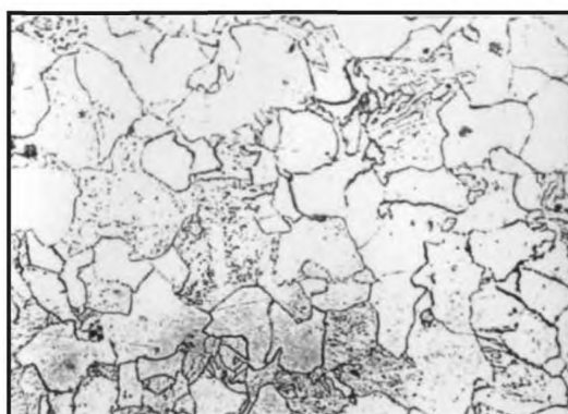
Балл 6, 500 \times , химическое травление
