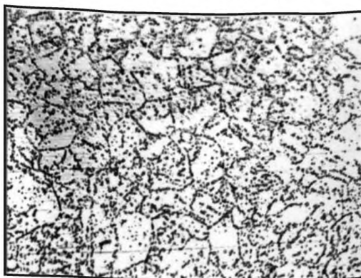
Балл 1, 500 \times , электролитическое травление
