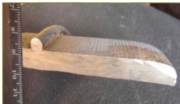
Рисунок Д.7 — Утонение гладкого конца трубы
