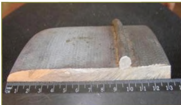
Рисунок Д.7 — Утонение гладкого конца трубы
