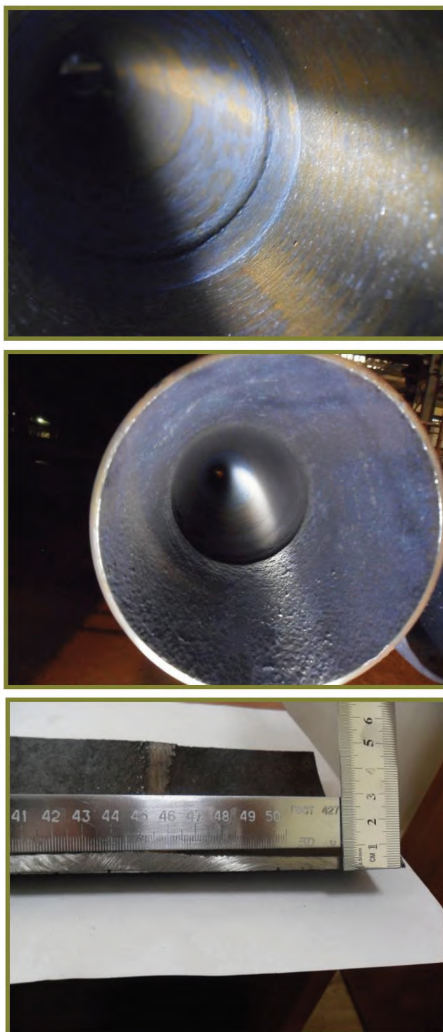
Рисунок Д.10 — Нарост, залив, грубая поверхность
