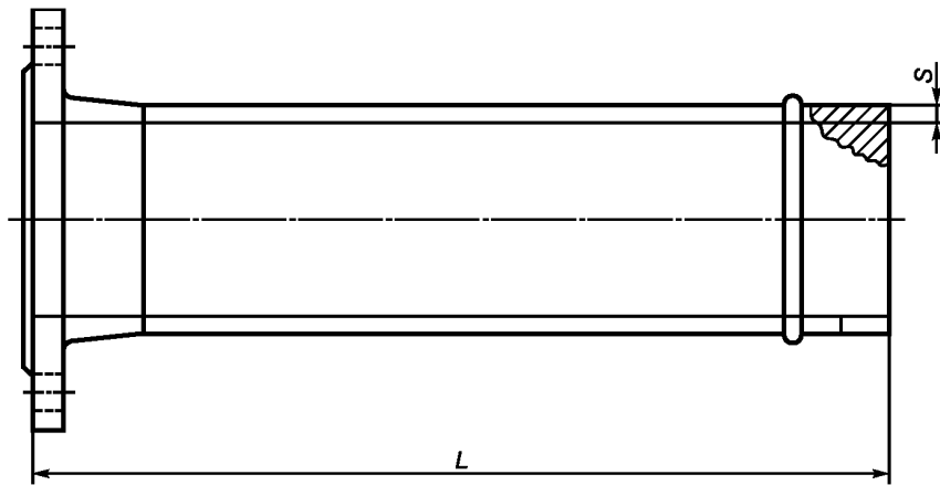
Рисунок Б.9 — Патрубок, фланец — гладкий конец (ПФГ)
